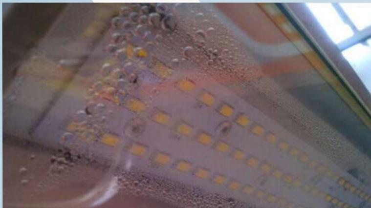
Разборные, пустотелые светильники не обеспечивают нужную защиту и выходят из строя из-за образовавшейся внутри влаги и конденсата. В отличие от Moonrock
